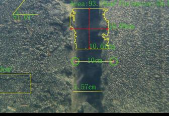
QYSEAの精密測定システムは、精密測定のためのデータを迅速にインポートし、さまざまな測定範囲をミリ単位の精度で一度に測定できます。
