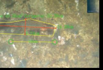
多角度・多形状での操作を行い、99.7%の精度で水中測定を実施。
